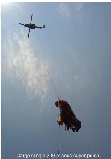
Cargo sling à 200 m sous super puma
