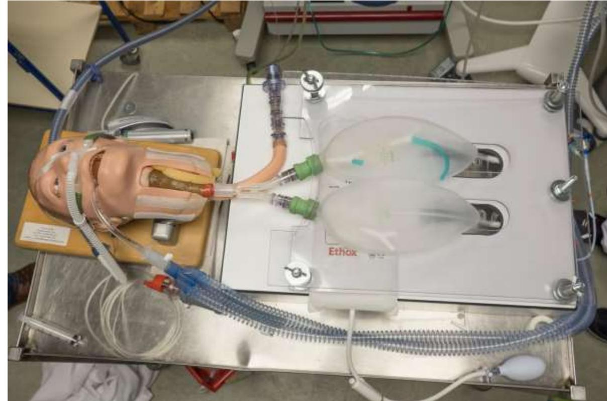
Figure 3, vue supérieure du simulateur de voies aériennes, ici intubé pour calibration avec les canules nasales d'oxygénothérapie a haut débit déjà en place.
