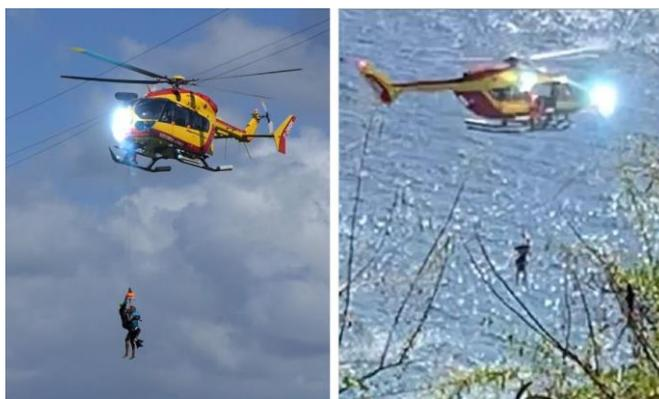
*Illustration 2 : Arc électrique au niveau de la potence de treuil et du nez de l'appareil*
