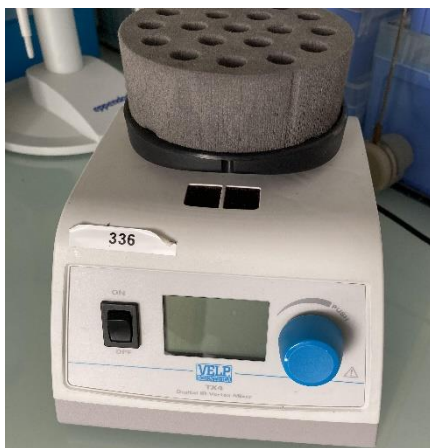
Figure 4 : Vortex TX4 digital IR Mixer utilisé pour le mélange des solutions. Source : Institut de Recherche Biomédicale des Armées, Brétigny sur Orge 91220.
