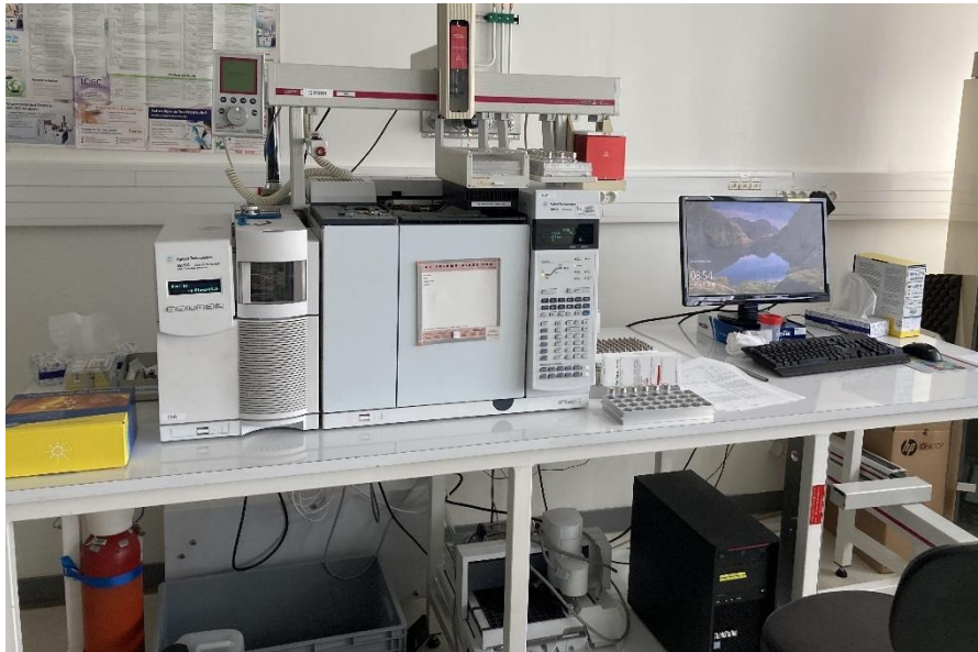
Figure 3 : Représentation d'ensemble du système de chromatographie en phase gazeuse et du spectromètre de masse avec leur PC d'exploitation. Source : Institut de Recherche Biomédicale des Armées, Brétigny sur Orge 91220.
