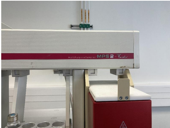
Figure 6 : Passeur d'échantillon MPS ROBOTIC 2 twister chargé de chauffer la préparation, de mélanger, de ponctionner l'espace de tête et de l'injecter dans le système de chromatographie. Source : Institut de Recherche Biomédicale des Armées, Brétigny sur Orge 91220.
