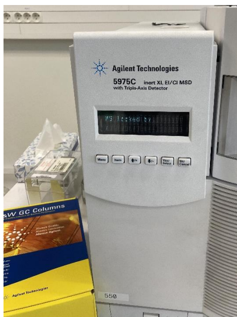
Figure 8 : Spectromètre de masse 5975C (AGILENT). Source : Institut de Recherche Biomédicale des Armées, Brétigny sur Orge 91220.
